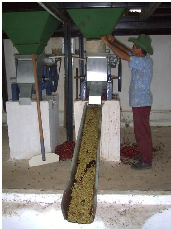
**Figura 13.2. Despulpado sin agua**
